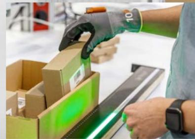
**LICHT- UND FARBSIGNALE ZEIGEN** dem Mitarbeiter an, wie er die Artikel in einem Karton so platzsparend wie möglich verpackt. Das einfache und günstige System bietet eine individuelle und effektive Unterstützung für den Mitarbeiter. Es erleichtert die Einarbeitung und trägt zur Minimierung von Stress bei.
