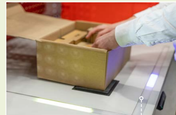
EINGEBETTETE LED-LEISTEN sowie integrierte und federnd gelagerte Anschlagkante
