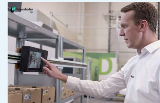
»mika« gleitet auf einer Fahrtschiene am Regal entlang – immer im Kontakt mit dem Kommissionierer.
