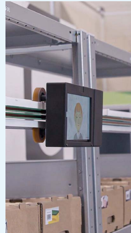
»mika« gleitet auf einer Fahrtschiene am Regal entlang – immer im Kontakt mit dem Kommissionierer.
