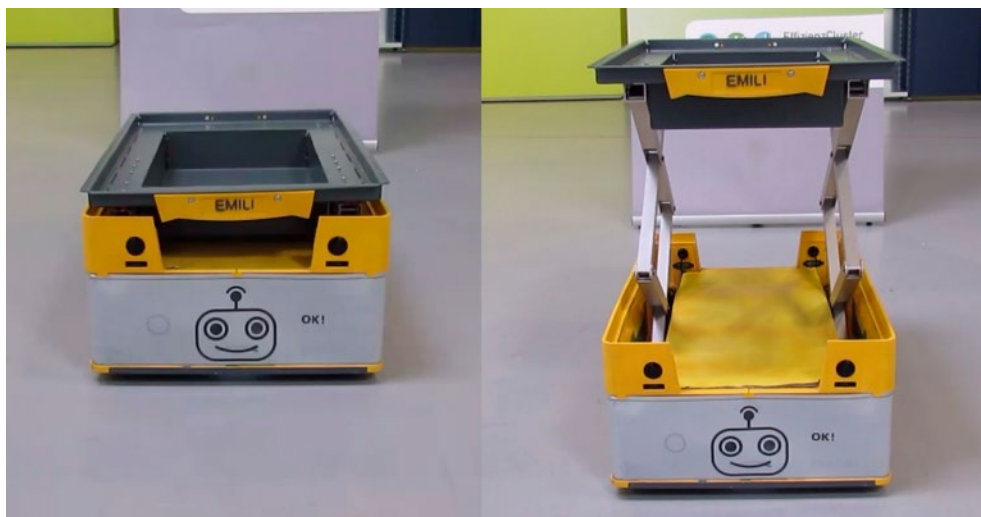
Abbildung 8: Abbildung des Fahrerlosen Trans- portsystems Emili
