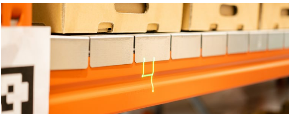
Abbildung 7: Entnahmeinforma- tionen werden unmittelbar auf das Regal projiziert
