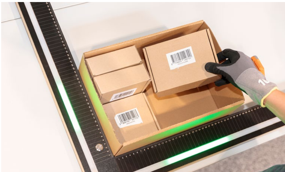
Abbildung 5: Lichtgestützte Verpackungsunter- stützung durch das »passt«-System
