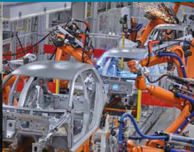
2015: Moderne Autoproduktionsstraße: Roboter erledigen einen Großteil der schweren, repetitiven und präzisen Arbeit.
